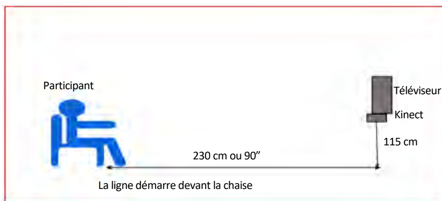
Figure 2 : Configuration du Kinect. Vue de côté.
