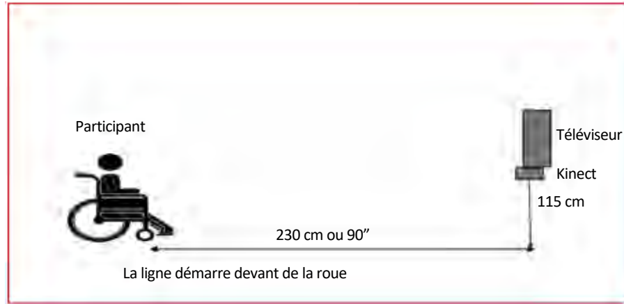
Figure 3 : Configuration du Kinect pour un patient en fauteuil roulant. Vue de côté.
