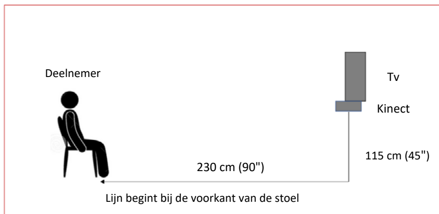
Afbeelding 2: Kinect instellen. Zijaanzicht.
