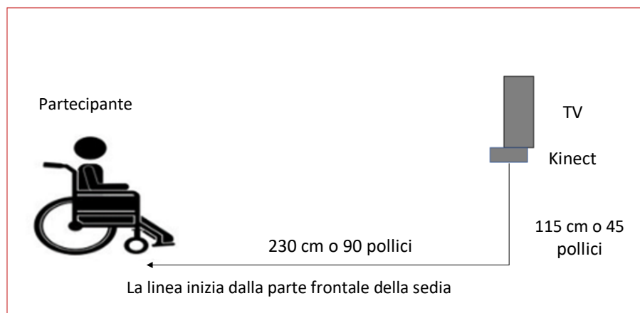
Figura 3: Posizionamento di Kinect per un paziente sulla sedia a rotelle. Vista laterale.
